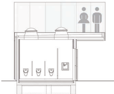
Schnitt durch den Urinalraum © gruppeomp architekten
